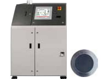
Autom. Mahl- und Pressanlage (3), analysefeine Tablette
