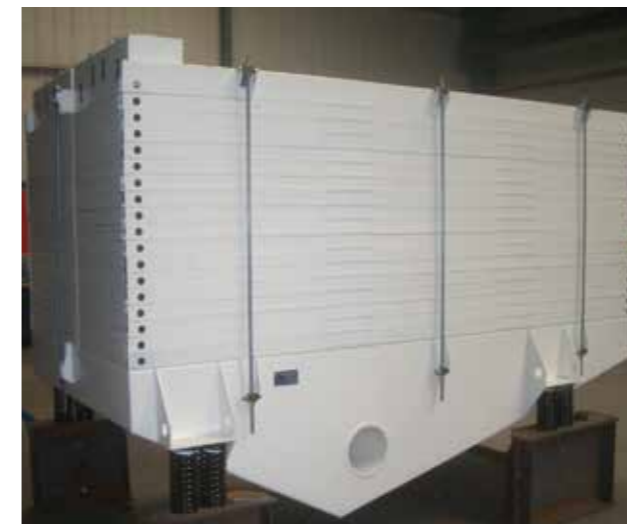
Produktions-MHR 20/28/XVII (2 IIX) Breite 2000 mm, Länge 2800 mm, mit 17 Decks und zwei Siebeinheiten
